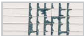
BEZ Allgrund: Odspojenia lakieru
